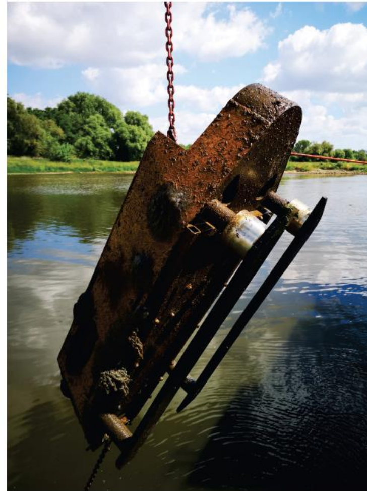
Station 01 / Rogätz: Bergung der Bodenstation mittels Tonnenleger, starke Verschmutzungen erkennbar
